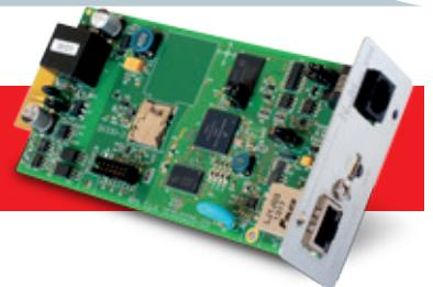
Сетевой агент NetMan 204 позволяет управлять ИБП, непосредственно подключенным по LAN 10/100 Мбит, с помощью основных протоколов сетевого обмена информацией (TCP/IP, HTTP и SNMP). Это идеальное решение для интеграции ИБП в сетях Ethernet с протоколами Modbus/TCP или BACnet/IP. Он был разработан для интеграции ИБП в сетях средней и большой емкости для обеспечения высокого уровня надежности в процессе обмена информацией между ИБП и связанными с ним системами управления.
